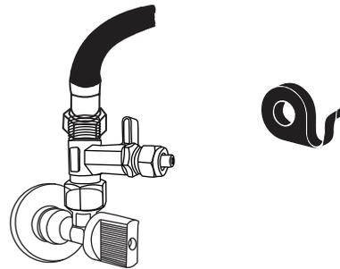
3. Colocar tubo 1/4 en la pieza de metal previamente colocada.
